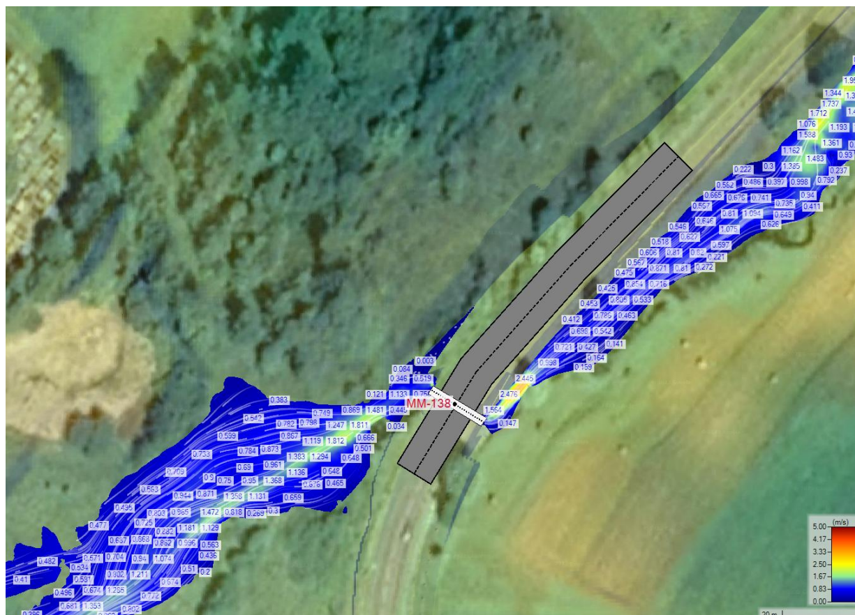
Rysunek 139. Rozkład poziomów wody Q_{maxp0.5\%} dla obiektu MM-138.
