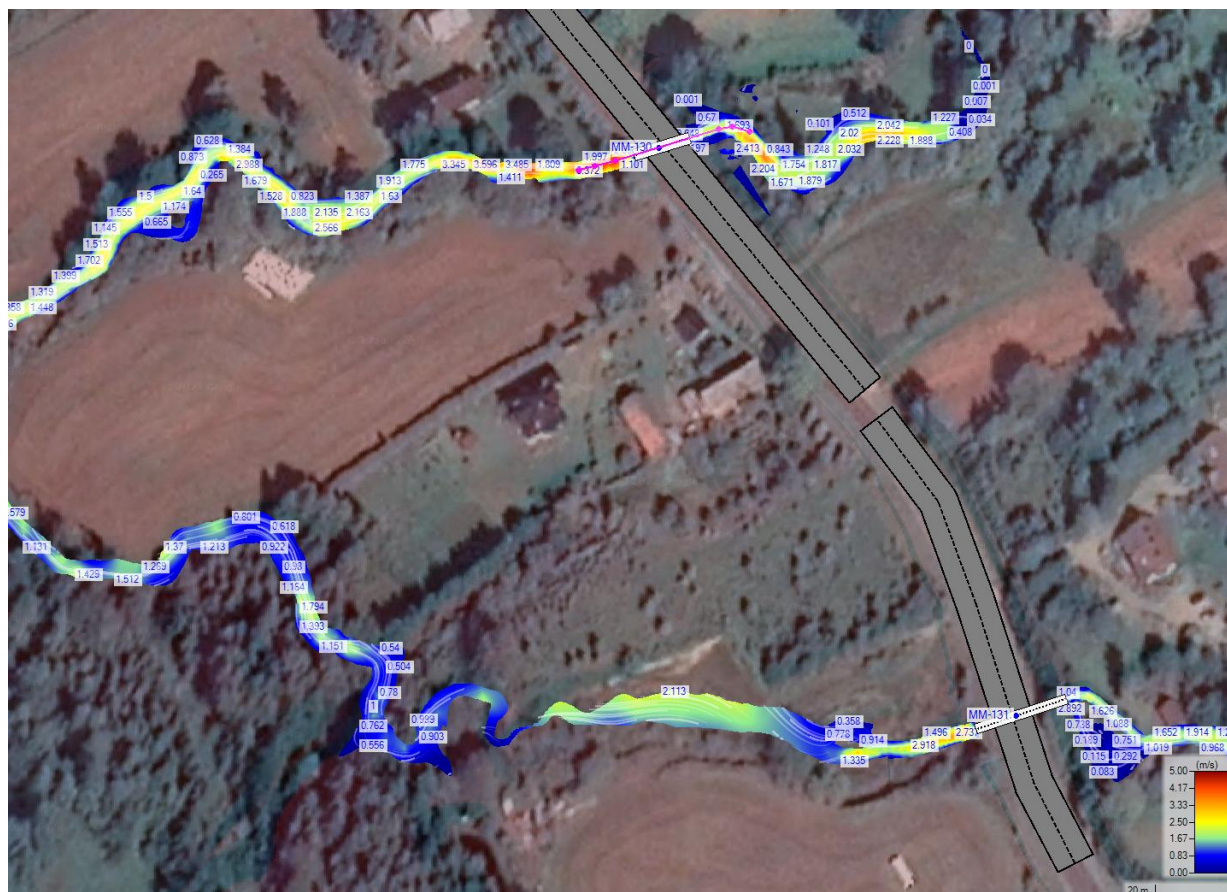
Rysunek 117. Rozkład prędkości wody Q_{maxp0.5\%} – zakres analizy dla obiektów -130 i MM-131.
