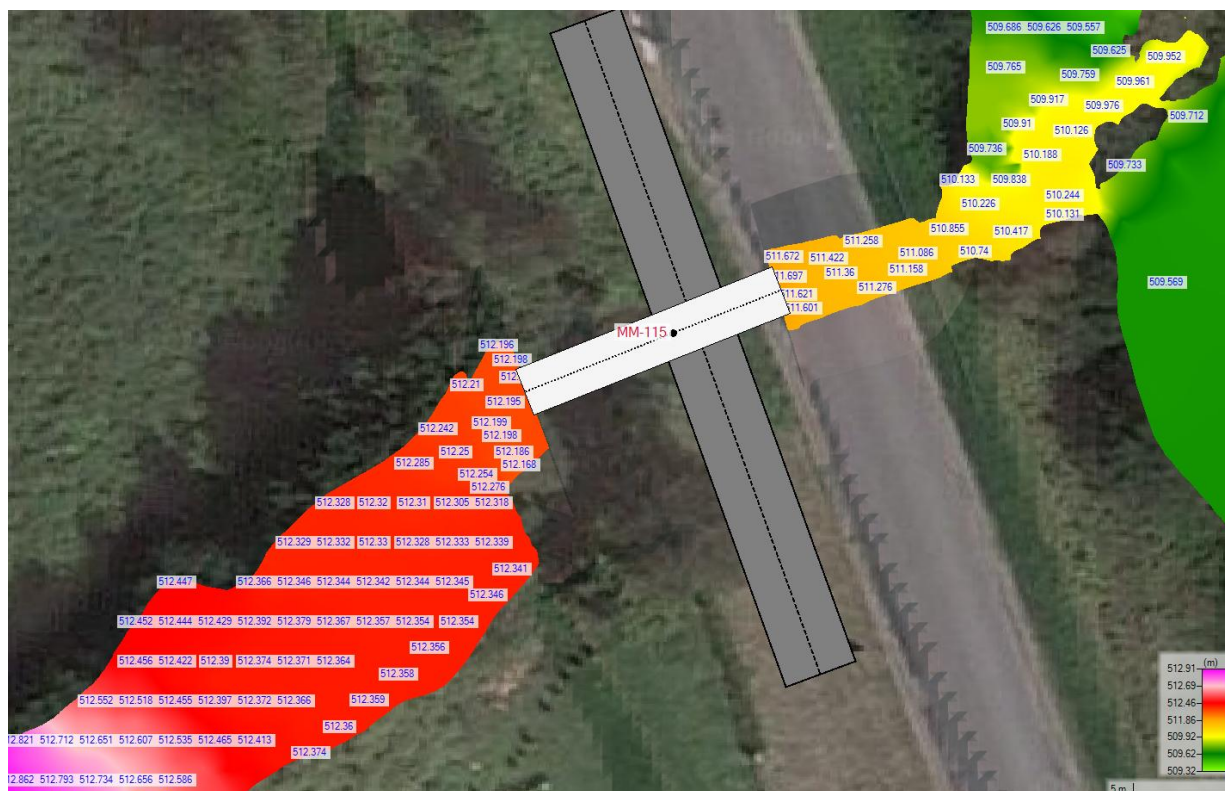
Rysunek 78. Rozkład poziomów wody Q_{maxp0.5\%} dla obiektu MM-115.
