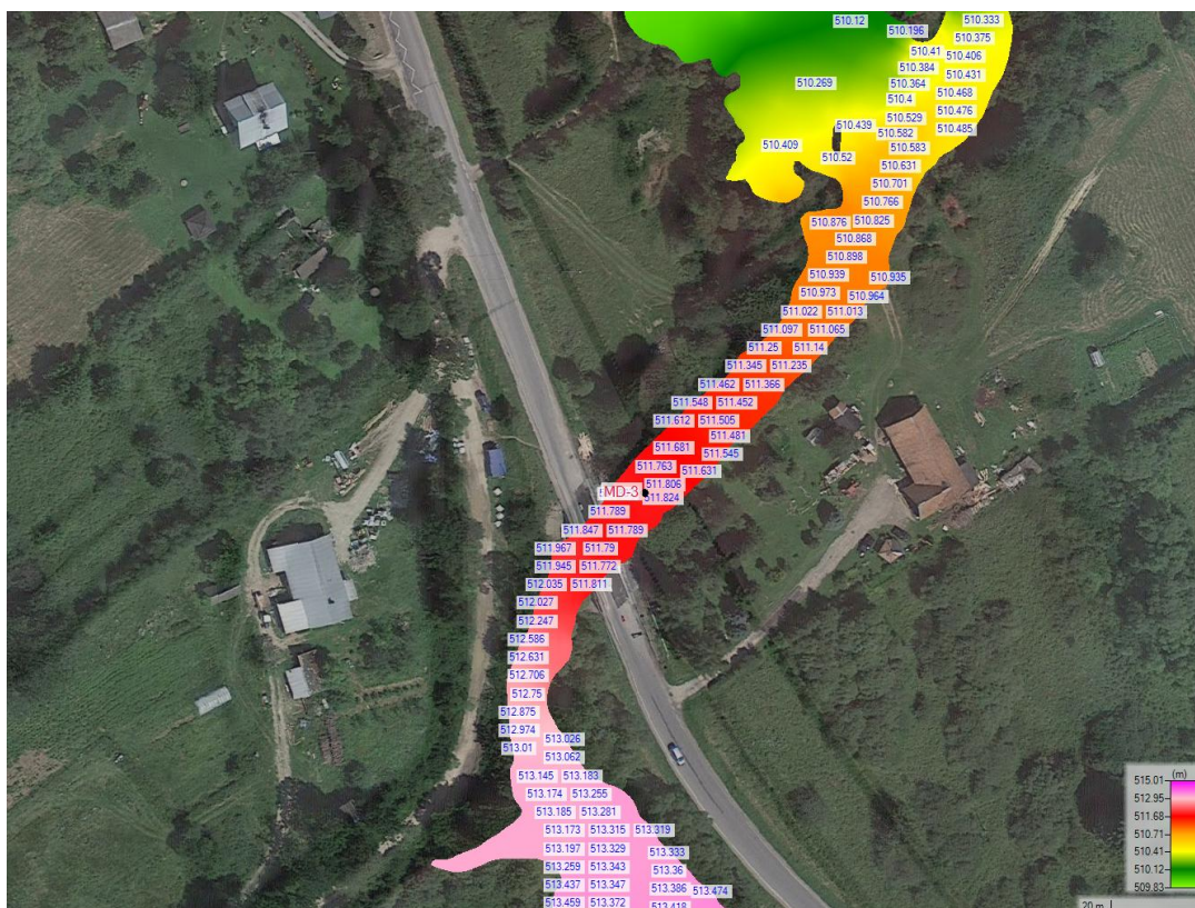
Rysunek 21. Rozkład poziomów w rejonie projektowanego mostu MD-3 na rzece Pastewnik – Q_{maxp0.5\%} .
