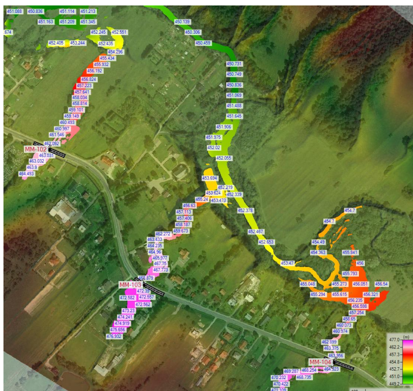
Rysunek 40. Rozkład poziomów wody Q_{max0.5\%} – zakres analizy dla obiektów MM-102, MM-103 i MM-104.
