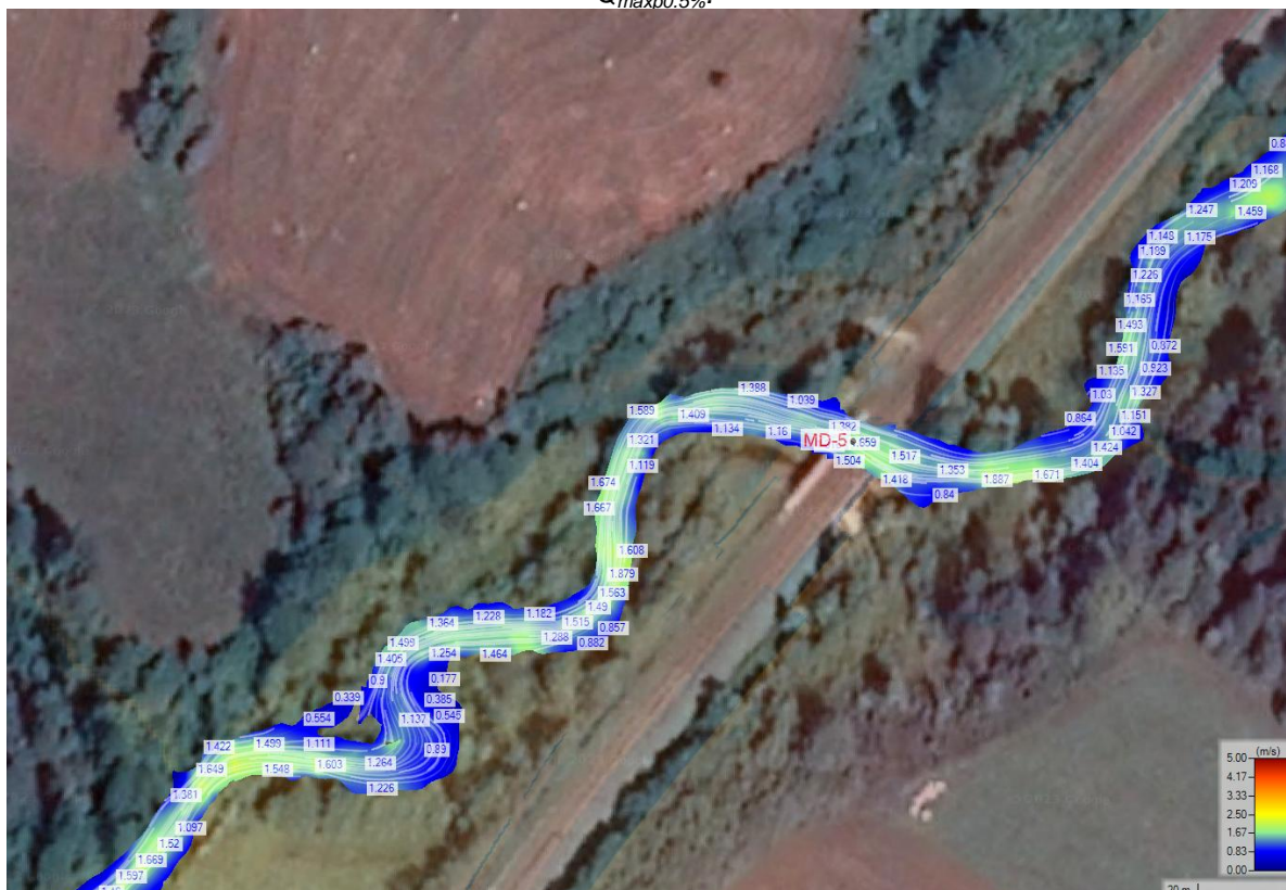
Rysunek 31. Rozkład prędkości w rejonie projektowanego mostu MD-5 na Dopływie spod Żłobka – Q_{maxp0.5\%} .
