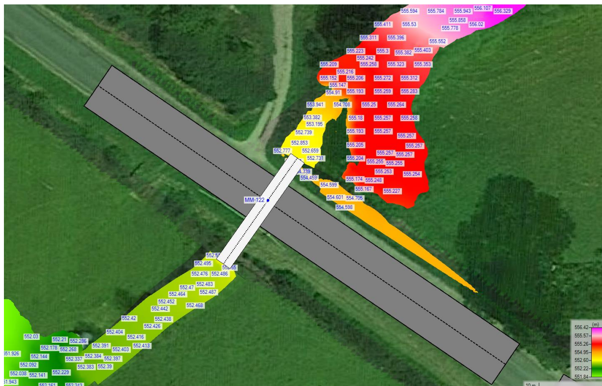
Rysunek 96. Rozkład poziomów wody Q_{maxp0.5\%} dla obiektu MM-122.
