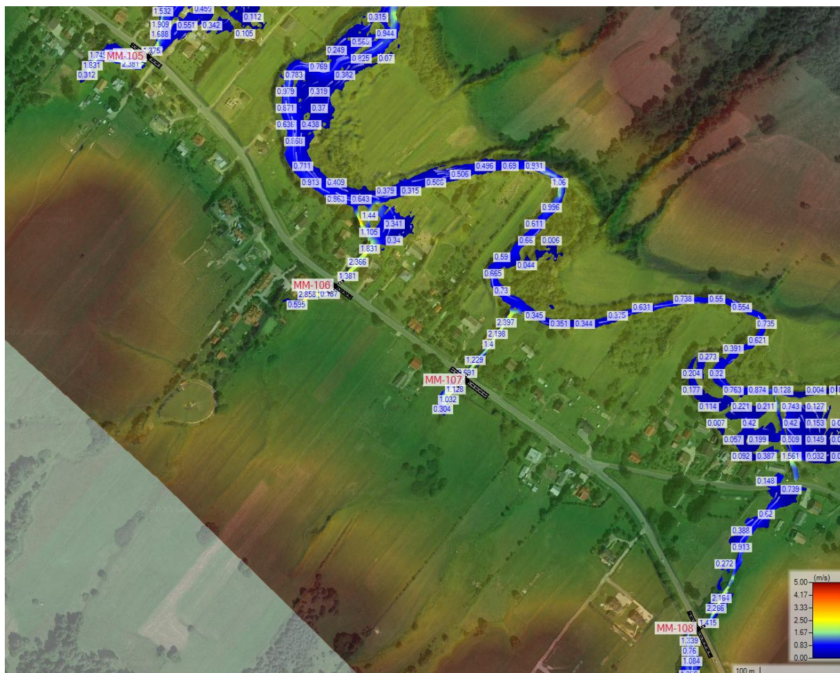
Rysunek 52. Rozkład prędkości wody Q_{max0.5\%} – zakres analizy dla obiektów MM-105, MM-106, MM-107 i MM-108.
