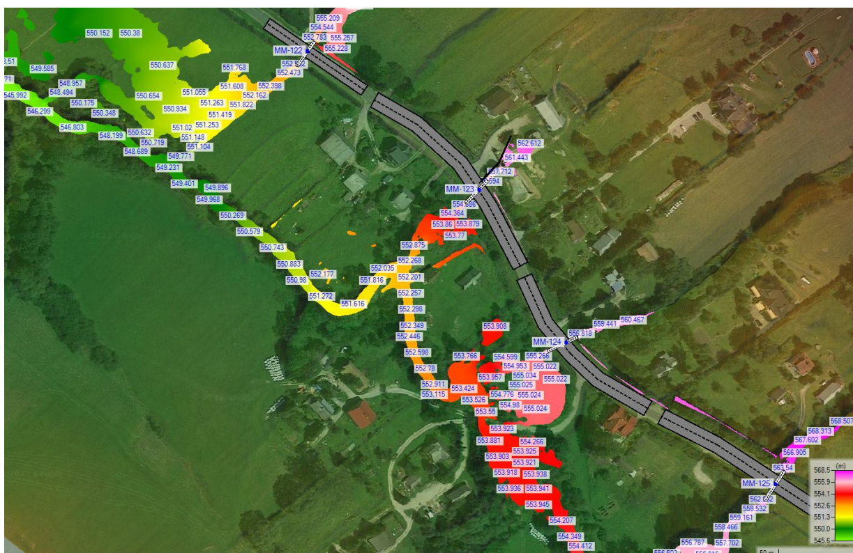
Rysunek 94. Rozkład poziomów wody Q_{maxp0.5\%} – zakres analizy dla obiektów MM-122, MM-123, MM-124 i MM-125.
