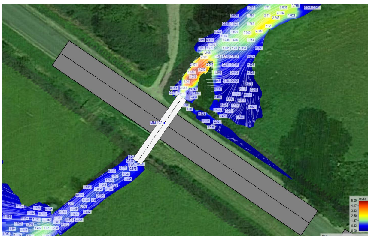
Rysunek 97. Rozkład prędkości wody Q_{maxp0.5\%} dla obiektu MM-122.
