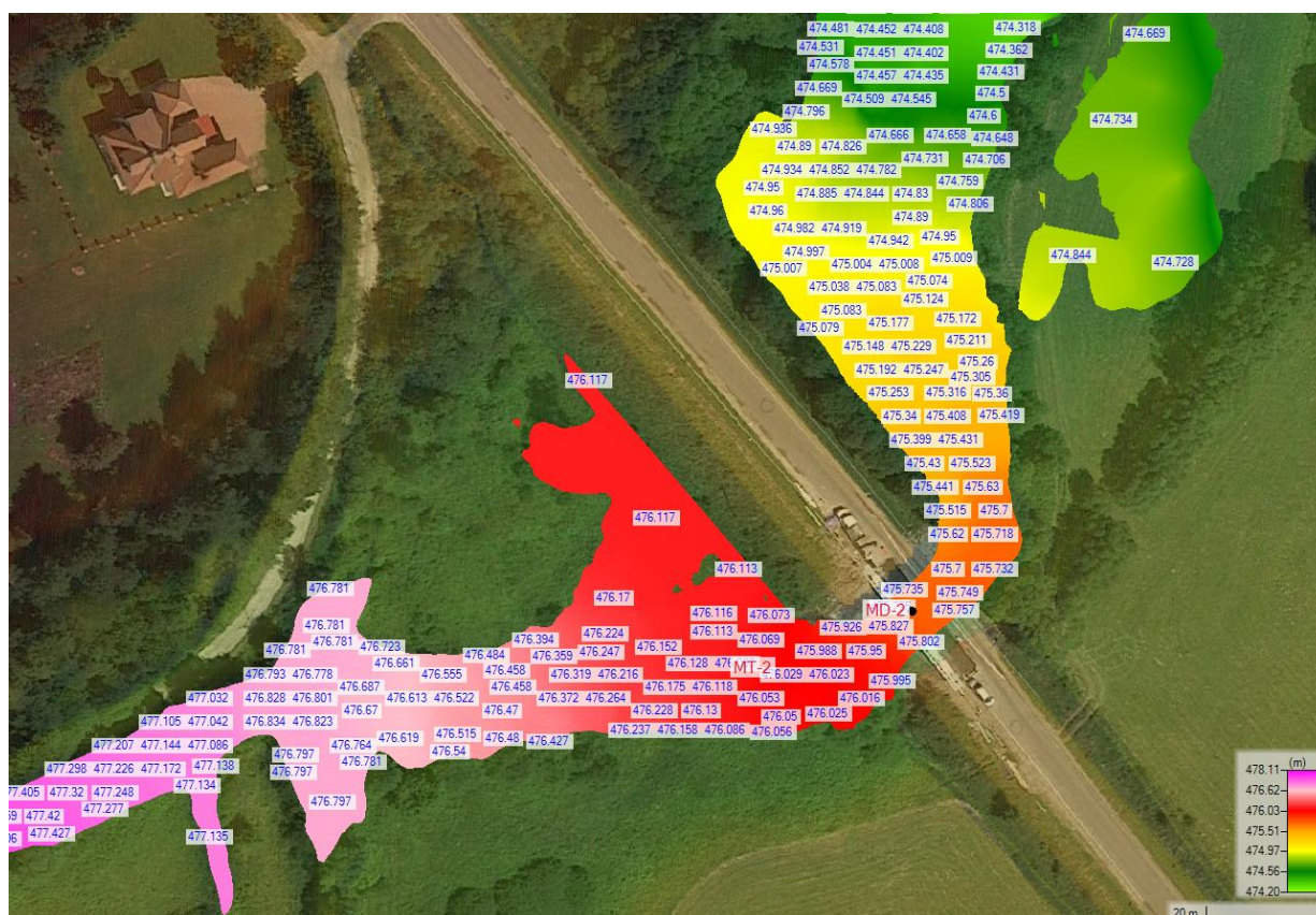
Rysunek 142. Rozkład poziomów w rejonie tymczasowego mostu MT-2 na rzece Hoszowczyk – Q_{max5\%} .
