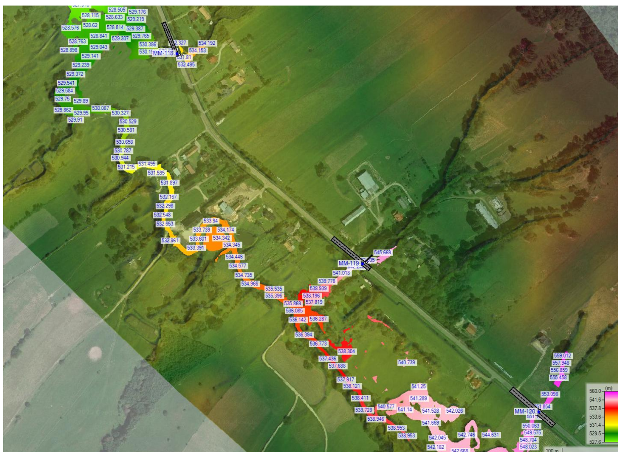
Rysunek 83. Rozkład poziomów wody Q_{max0.5\%} – zakres analizy dla obiektów MM-118, MM-119 i MM-120.
