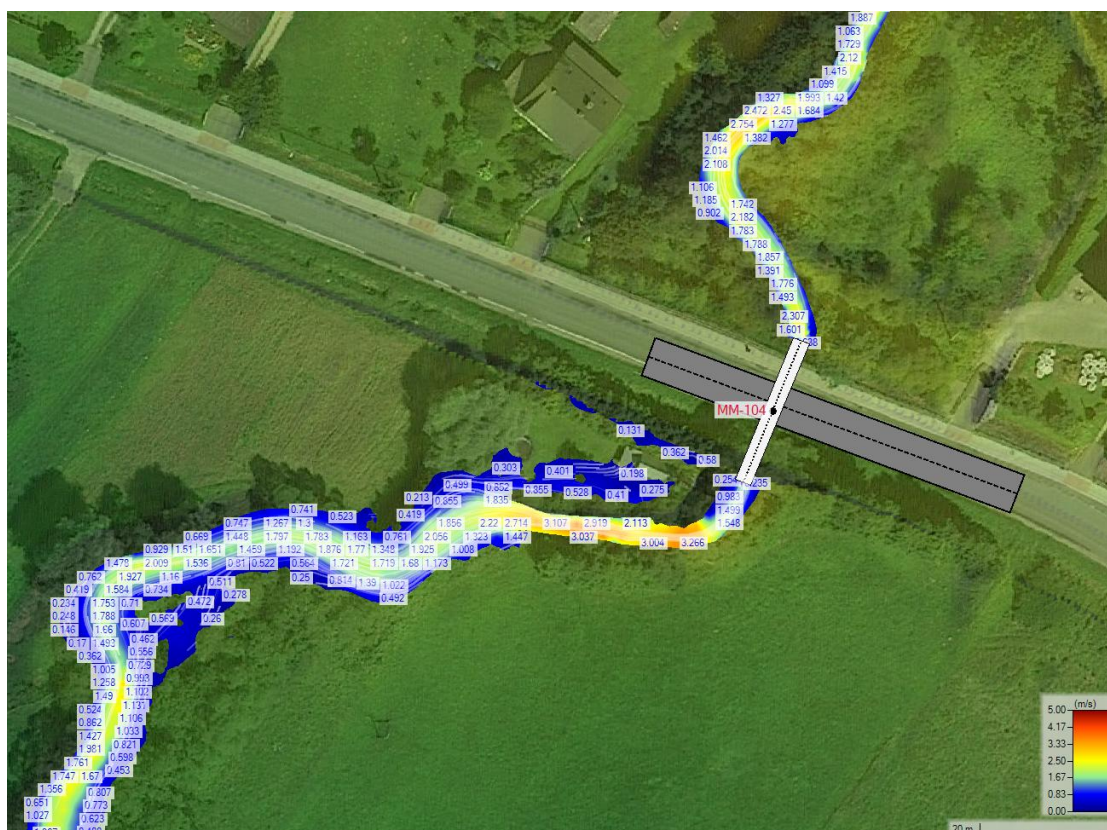
Rysunek 49. Rozkład prędkości wody Q_{maxp0.5\%} dla obiektów MM-104.
