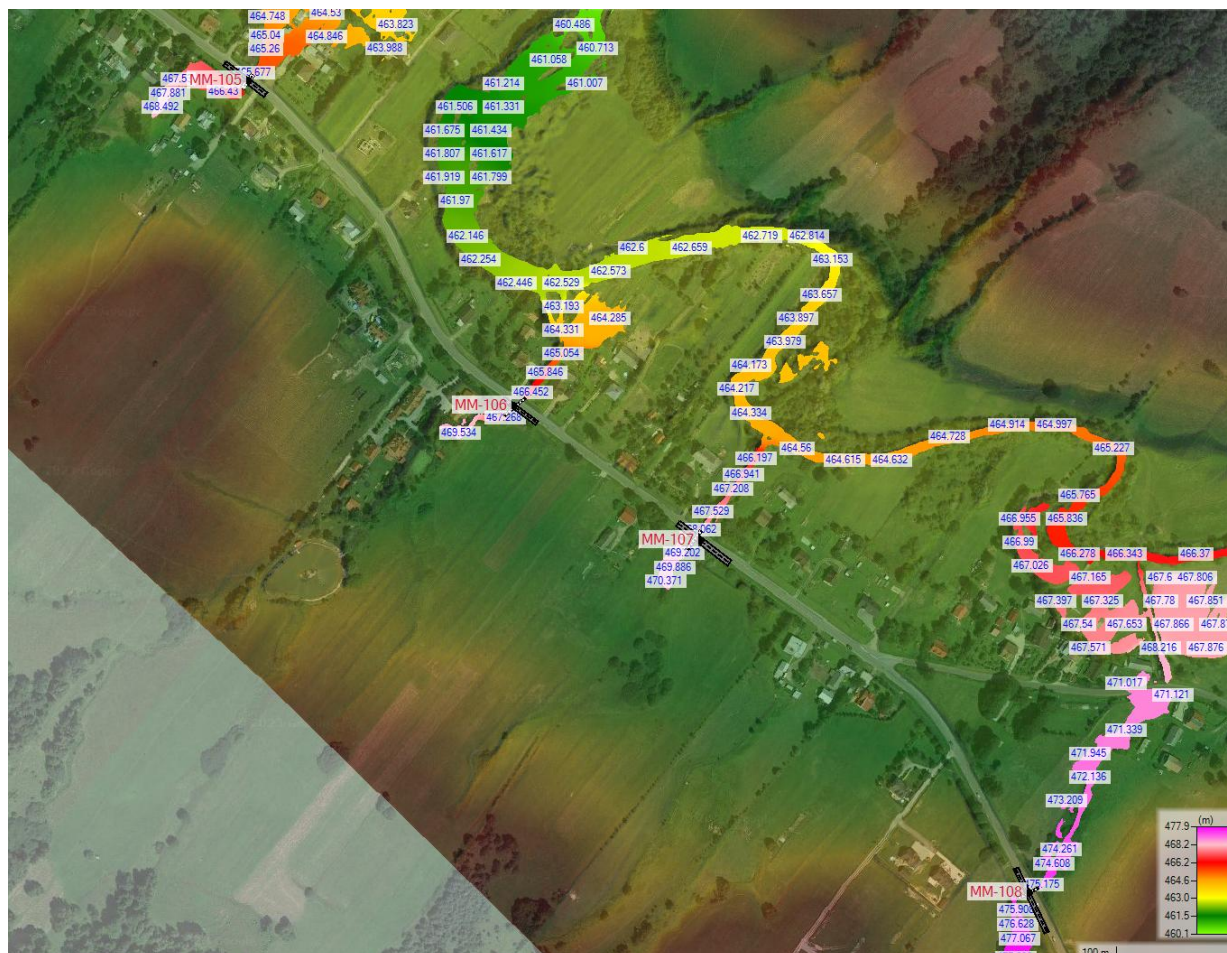
Rysunek 51. Rozkład poziomów wody Q_{max0.5\%} – zakres analizy dla obiektów MM-105, MM-106, MM-107 i MM-108.
