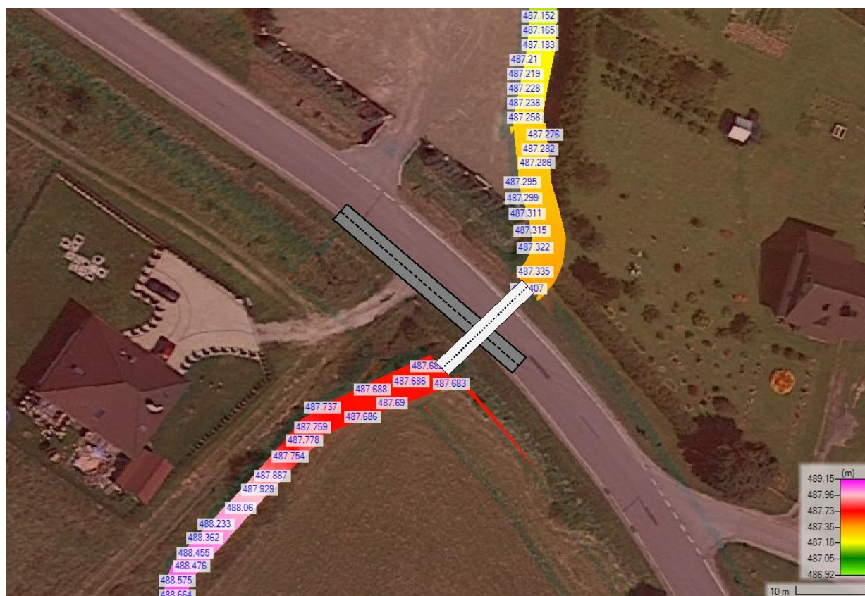
Rysunek 70. Rozkład poziomów wody Q_{max0.5\%} dla obiektu MM-110.
