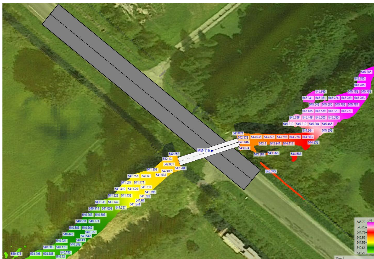
Rysunek 88. Rozkład poziomów wody Q_{maxp0.5\%} dla obiektu MM-119.
