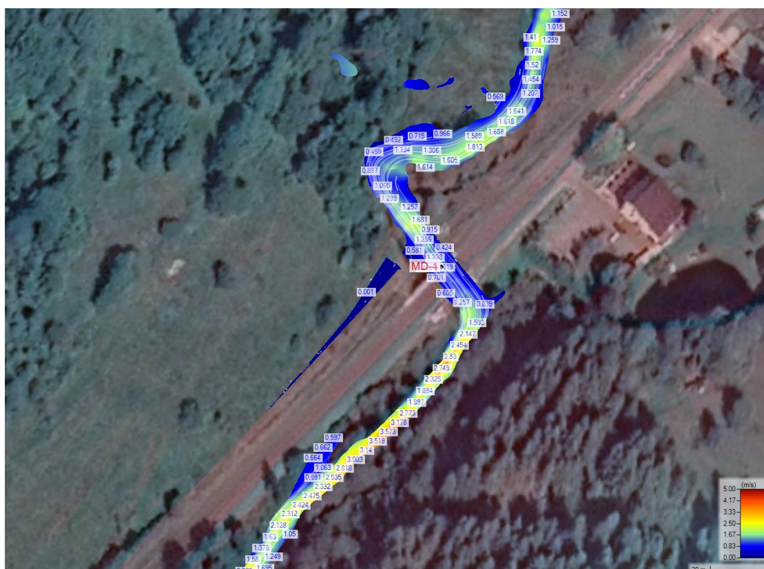
Rysunek 28. Rozkład prędkości w rejonie projektowanego mostu MD-4 na Dopływie spod Żłóbka – Q_{maxp0.5\%} .
