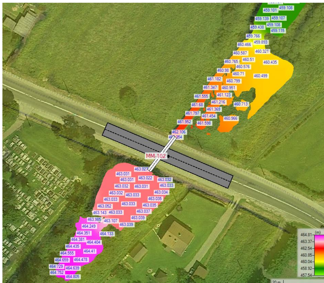
Rysunek 42. Rozkład poziomów wody Q_{maxp0.5\%} dla obiektu MM-102.
