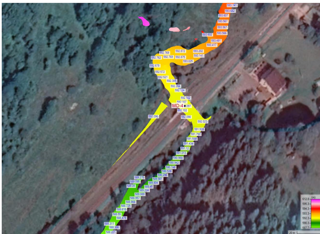
Rysunek 27. Rozkład poziomów w rejonie projektowanego mostu MD-4 na Dopływie spod Żłobka– Q_{maxp0.5\%} .
