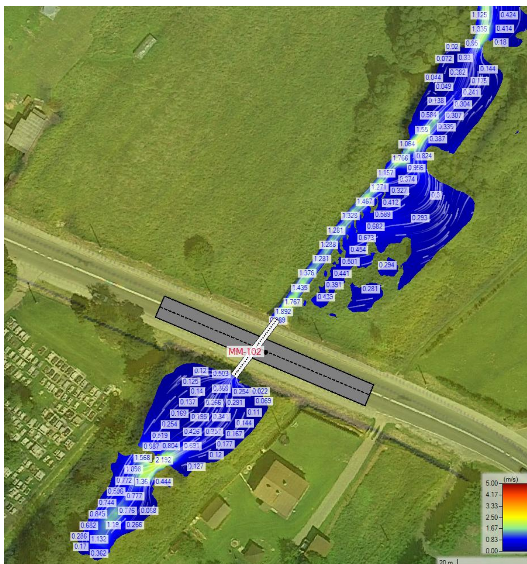
Rysunek 43. Rozkład prędkości wody Q_{maxp0.5\%} dla obiektu MM-102.
