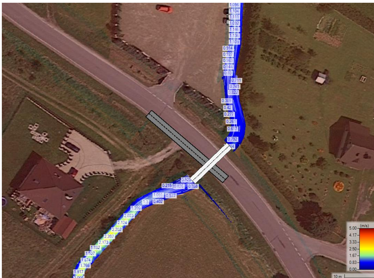
Rysunek 71. Rozkład prędkości wody Q_{max0.5\%} dla obiektu MM-110.
