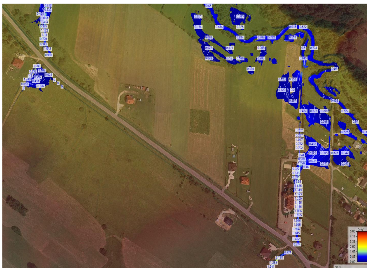
Rysunek 66. Rozkład prędkości wody Q_{maxp0.5\%} – zakres analizy dla obiektów MM-109 i MM-110.
