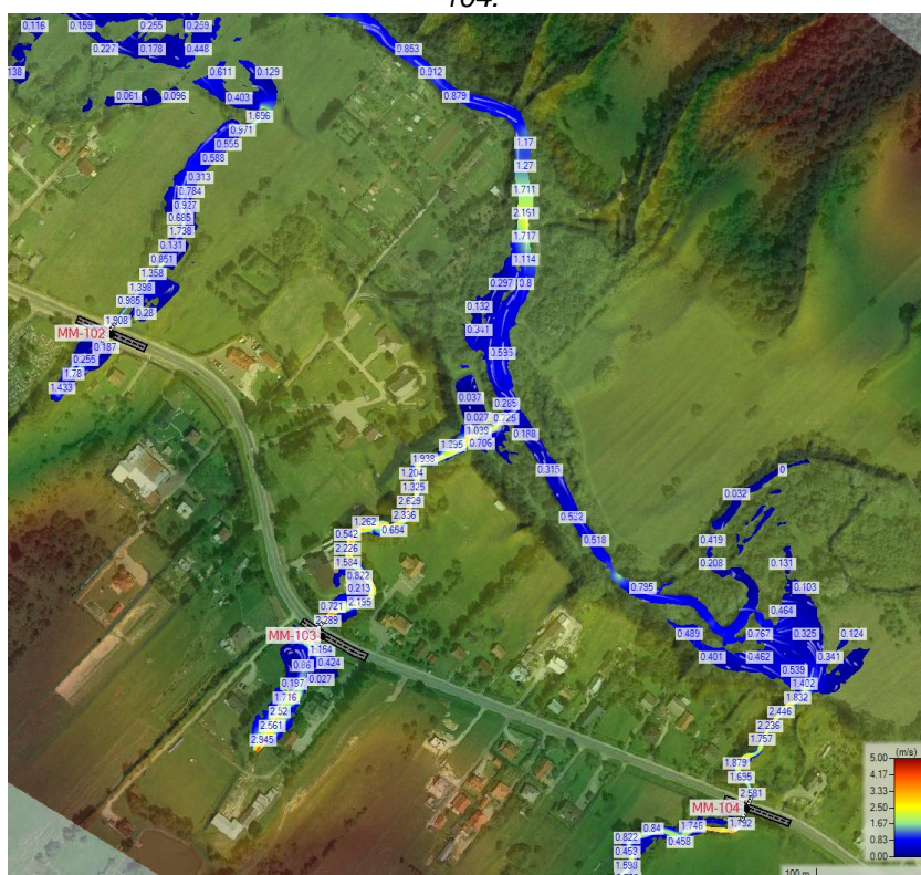
Rysunek 41. Rozkład prędkości wody Q_{max0.5\%} – zakres analizy dla obiektów MM-102, MM-103 i MM-104.
