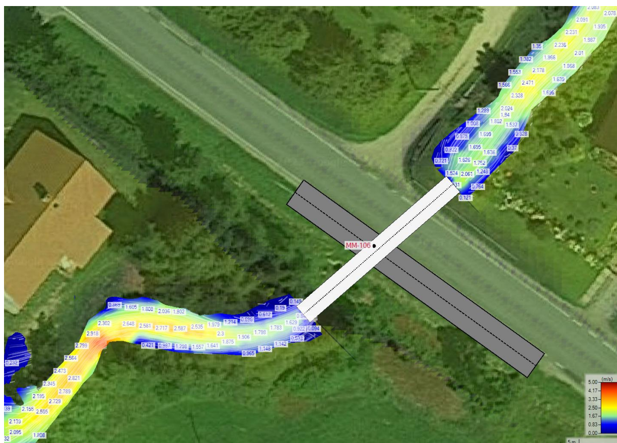
Rysunek 57. Rozkład prędkości wody Q_{maxp0.5\%} dla obiektu MM-106.
