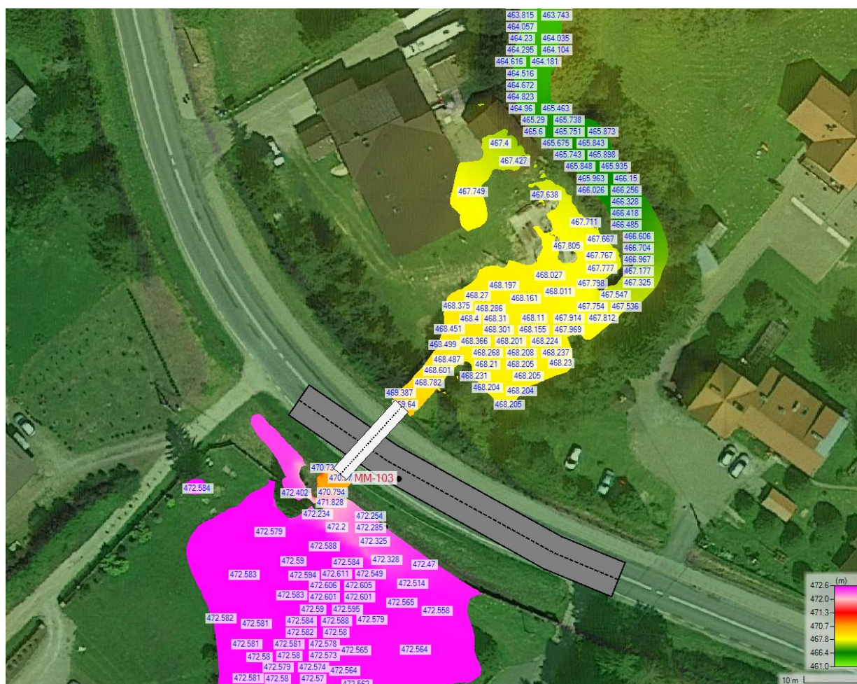
Rysunek 45. Rozkład poziomów wody Q_{maxp0.5\%} dla obiektu MM-103.
