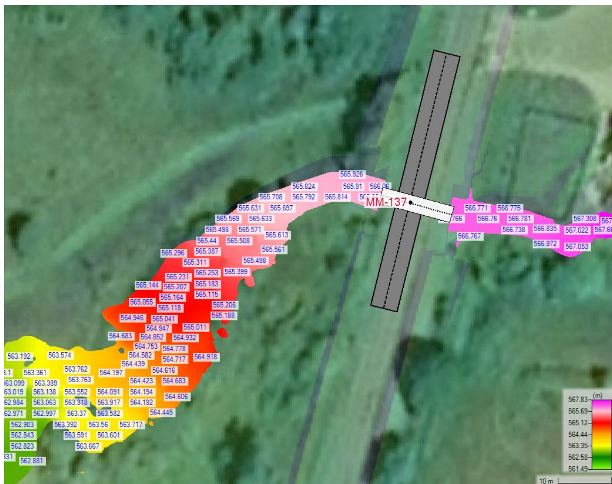
Rysunek 136. Rozkład poziomów wody Q_{maxp0.5\%} dla obiektu MM-137.
