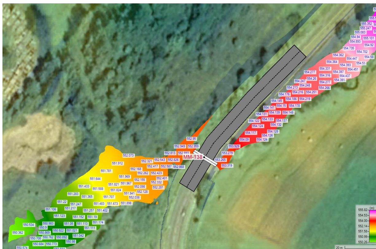
Rysunek 139. Rozkład poziomów wody Q_{maxp0.5\%} dla obiektu MM-138.
