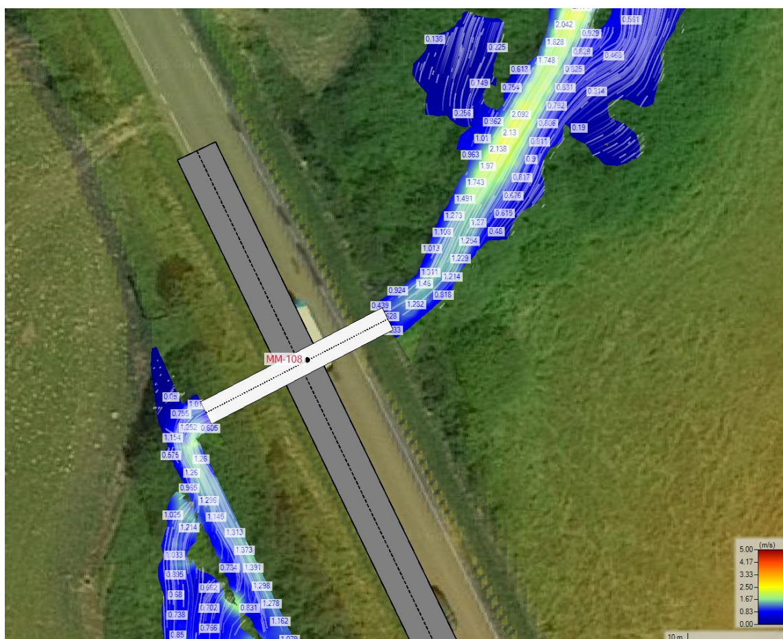
Rysunek 63. Rozkład prędkości wody Q_{maxp0.5\%} dla obiektów MM-108.
